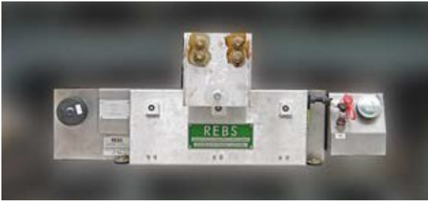
Sprühsystem mit Kompressor-Zentrale im Drehgestell
